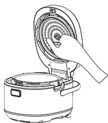
Cuando la tapa esté abierta, desenrosque la tuerca fija y retire la placa de cubierta.
