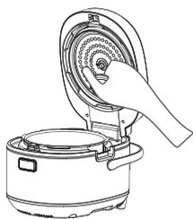
Lorsque le couvercle de l'autocuiseur est ouvert, dévissez l'écrou fixe et retirez le couvercle inférieur.
