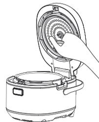
Instale a placa de cobertura na panela e fixe-a com a porca.
