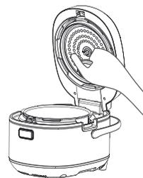
Coloque la placa en la olla y fíjela con la tuerca.
