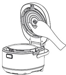
Quando a tampa da panela estiver aberta, desaperte a porca fixa e remova a placa de cobertura.
